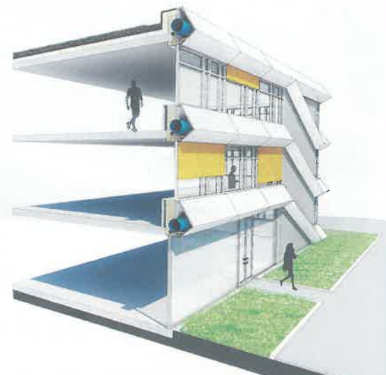
Omdat de gebouwen B en C niet geschikt zijn om moderne installatietechniek te verwerken, wordt dit 'verstop't' in de horizontale banen aan de gevel. (Afbeelding: LIAG architecten + bouwadviseurs)
